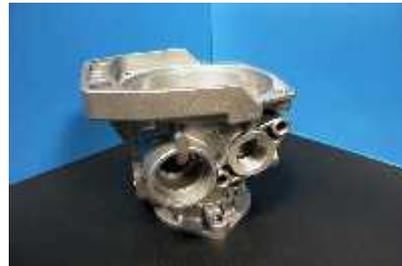
*Il processo di Impregnazione a Vuoto Loctite rimuove l'aria imprigionata nei particolari che accusano una certa porosità. Queste cavità vengono successivamente riempite con una resina sigillante Loctite molto fluida che, una volta polimerizzata, garantisce la perfetta impermeabilizzazione del componente.*
